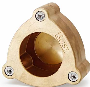
Die Küvette JST wurde in Zusammenarbeit mit ZTM Jürg Stuck entwickelt. Drei Innensechskantschrauben halten die Küvettenhälften zusammen und machen einen umständlichen Küvettenbügel überflüssig. Konische Stahlführungen zentrieren das Küvett-Ober- und Unterteil spaltfrei aufeinander. Bei der Anwendung der AESTHETIC Intensive Colors (mehrfarbiges Stopfen der Gingiva) kann durch die Möglichkeit des asymmetrischen Schliessens eine Verpressung verhindert werden.
