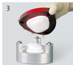
3 Gips auf dem Modell sowie dem POLYMASTER-Deckel anbringen und verschliessen.
